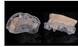
Bohrschablone, gedruckt mit Stratasys Printer
